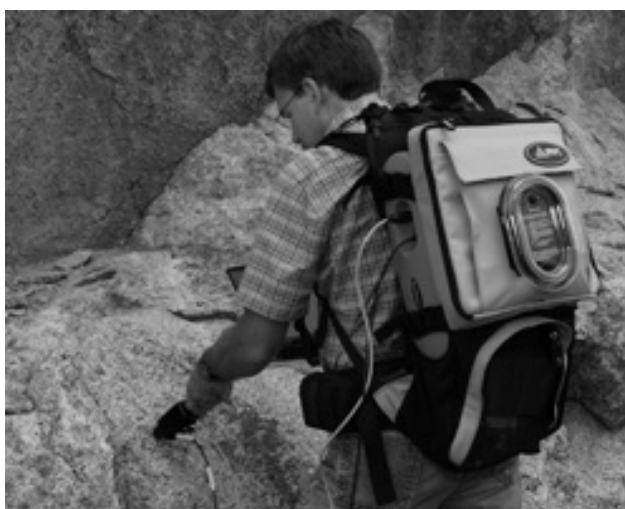
شکل ۲-۶- نمونه‌ای از یک دستگاه طیف‌سنج قابل حمل زمینی در حال اندازه‌گیری طیف یک رخنمون سنگی
